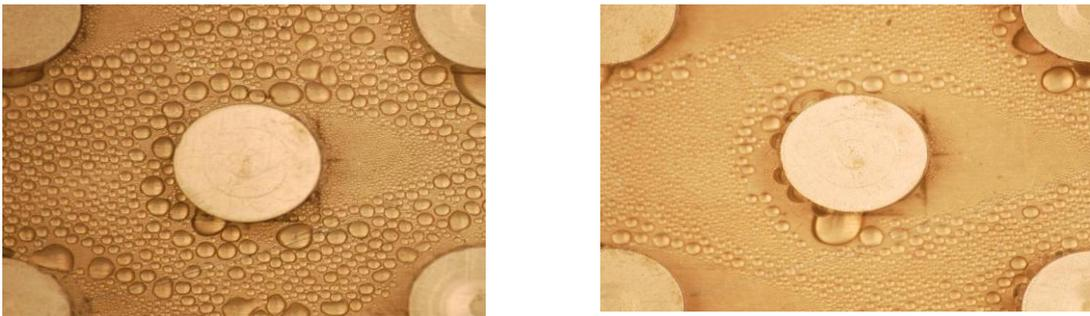
**Figure 3.10** : Distribution expérimentale du condensât : (gauche) HR 50%, (droite) HR 30%
