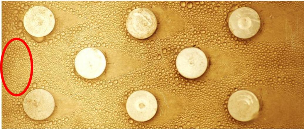
**Figure 3.12:** Concentration du condensât à l'entrée de la plaque
