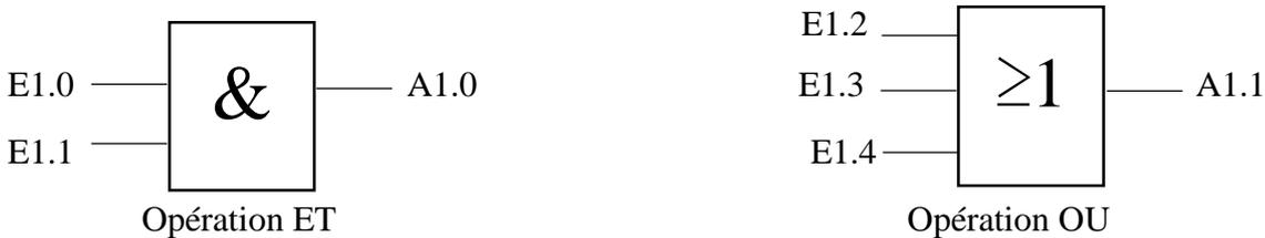
**Figure IV.8 :** Représentation des opérations ET et OU par LOG.
