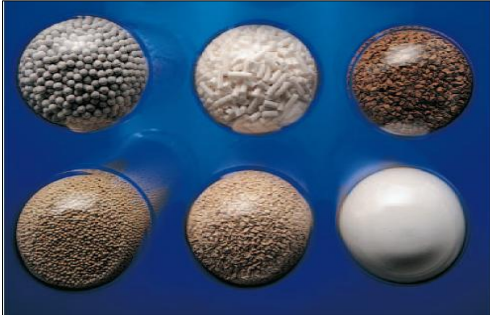
Figure III-6 : Tamis moléculaire sous ses différentes formes : à noter la différence de la taille des cristaux constituant la tamis
