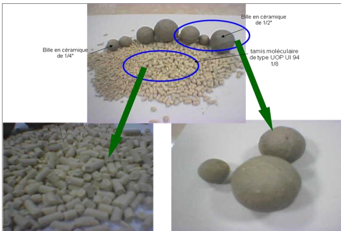
Figure III-7: Tamis moléculaire et les billes en céramique : les billes en céramique sont de différents diamètres (1/2 et 1/4 de pouce), le tamis et du type UOP UI 94 1/8.
