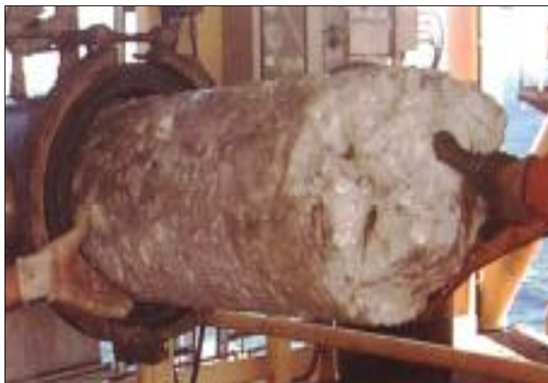
Figure III-3 : Bouchage des canalisations suite à la formation des hydrates de gaz
