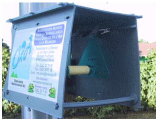
Figure 04 : Photo d'un abri pour tubes passifs
