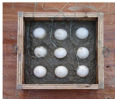
Figure IV-7 : Vue montrant l'insertion des balles dans le béton
