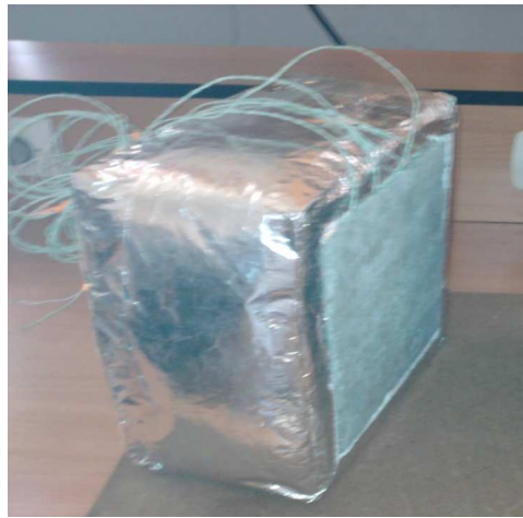
Figure IV-8 : Vue latérale du bloc en béton revêtu de son isolation thermique
