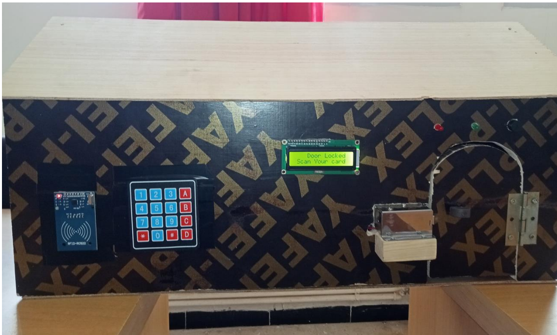
Figure III - 14: Test du montage avec lecteur RFID
