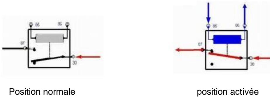
Figure II- 20: Principe de fonctionnement d'un Relais
