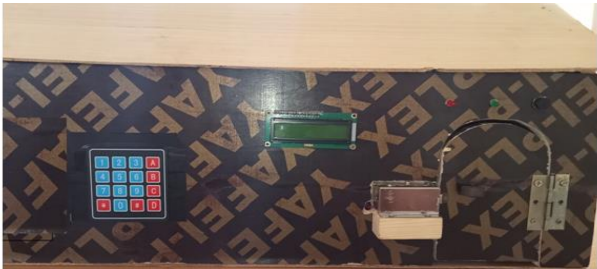
Figure III - 16: Test du montage avec clavier matriciel
