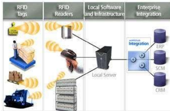
Figure I- 21: Principe d'une chaîne logistique complète contrôlé par RFID
