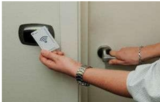
Figure I- 19 : RFID pour le contrôle d'accès
