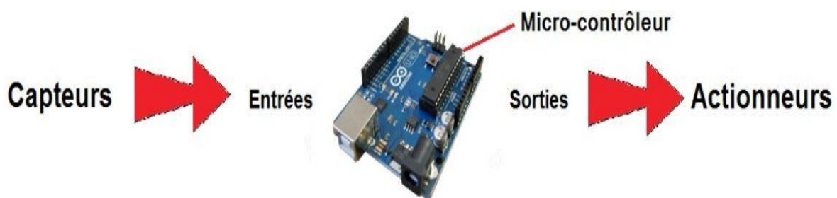
Figure II- 3: La carte Arduino UNO
