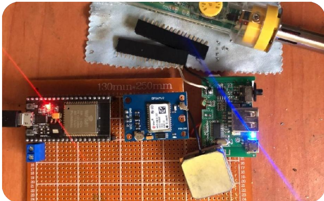
Figure 2. 7 : Circuit de navigation sur plaque de bakélite
