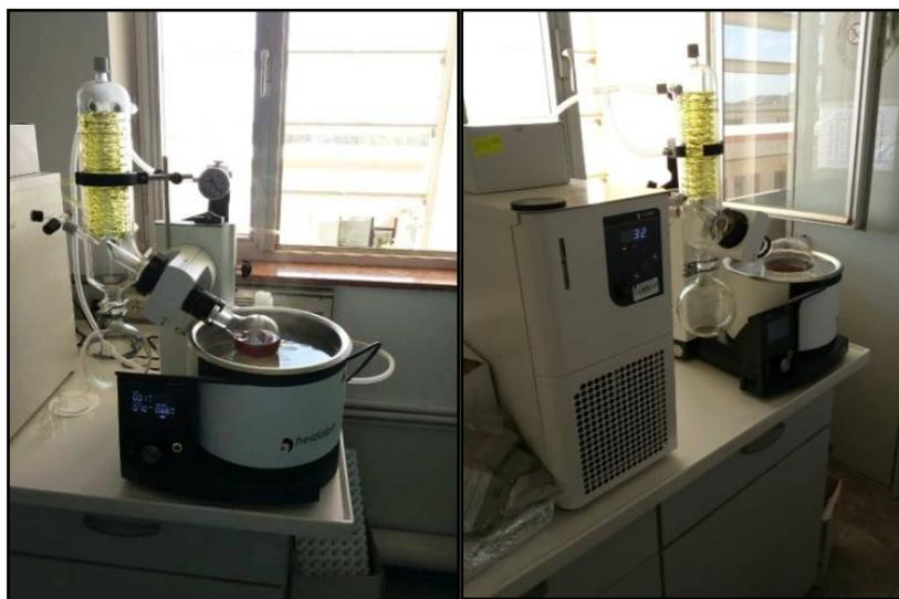
**Figure 15:** Schémas de montage d'évaporation de l'extrait de plante dans l'évaporateur rotatif (ou rotavap) à 70°C. (Photographie originale, 2021)
