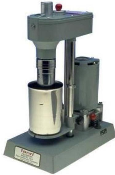
**Figure III.3 :** Viscosimètre FANN
