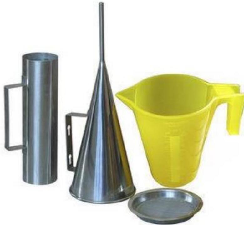
**Figure II.2 : Viscosimètre Marsh**
