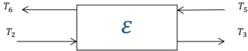
Figure II.5 : Bilan énergétique de l'échangeur
