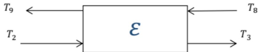
Figure II.7: Bilan énergétique du premier échangeur
