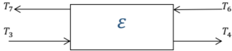
Figure II.8 : Bilan énergétique du 2 ème échangeur
