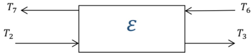
Figure II.3: Bilan énergétique de l'échangeur
