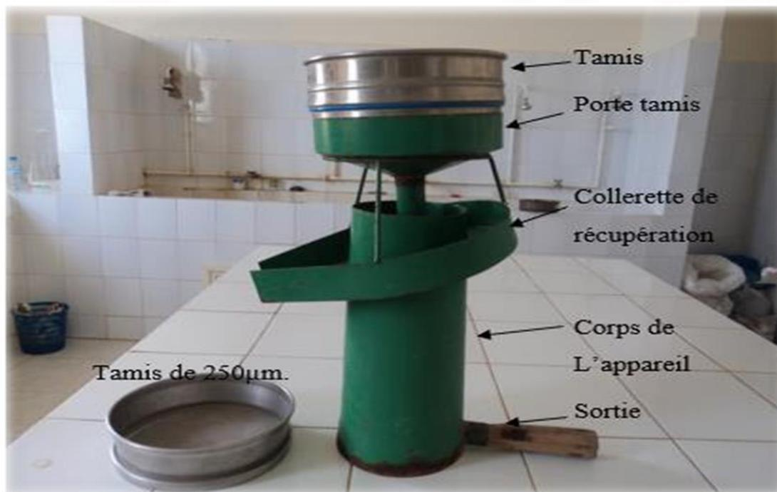
**Figure22 :Méthode d'extraction des nématodes à kyste appareil Fenwick (Fenwick, 1940).**
