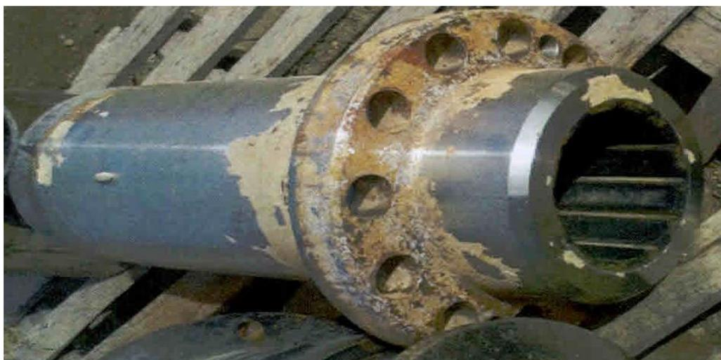
**Figure IV- 5: palier de guide inférieur**
