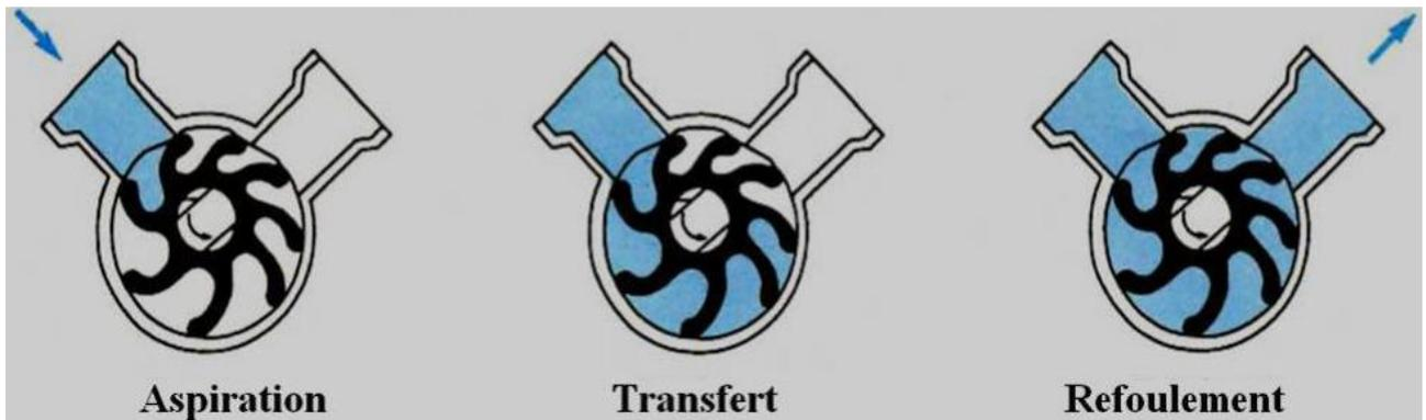
Figure II- 4: Pompes à palettes flexibles. [5]
