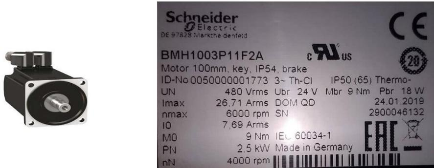
Figure II.14: Moteur défaillant de la TORNOS TBM 26 et sa plaque signalétique.
