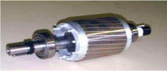
Figure II.20 : Rotor à cage d'écureuil.
