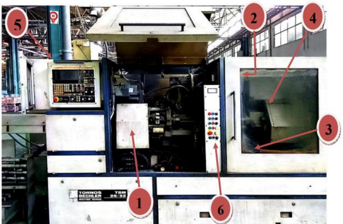
Figure I.1 : Machine à commande numérique de type TORNOS TBM 26/32.
