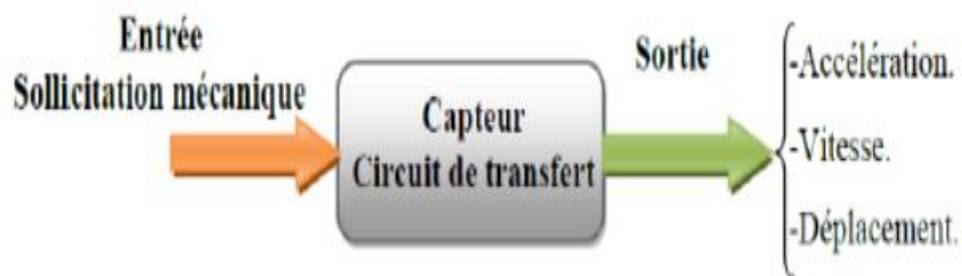
Figure 25 : Schéma de principe d'un capteur de vibration.
