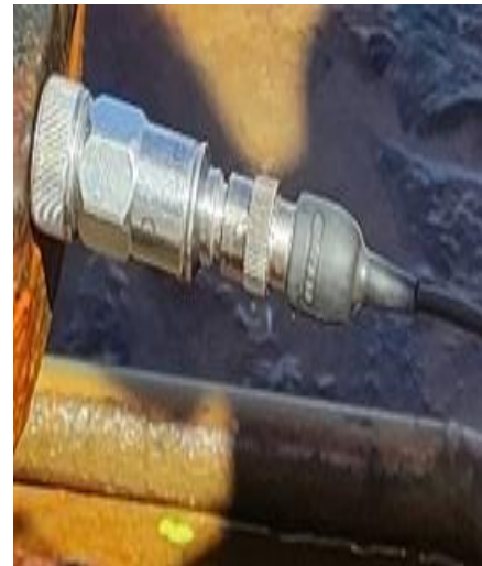
Figure 29 : Accéléromètre fonctionnant sur le principe piézo-électrique.
