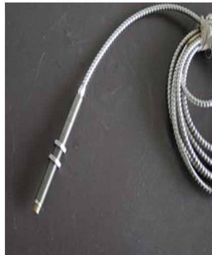
Figure 26: Capteur de déplacement (courants de Foucault).
