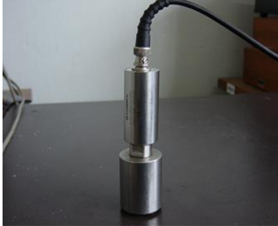
Figure 27: Capteur de vitesse (Vélocimétrie, VS 80).
