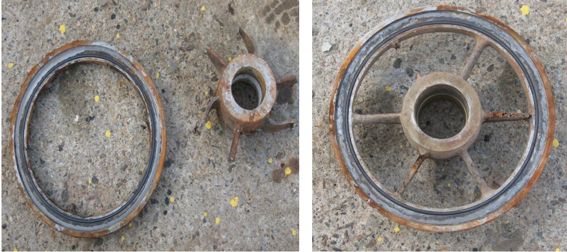
Figure 35 : Palier lisse endommagé
