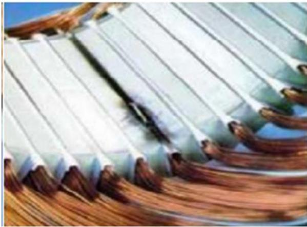
*Figure (I. 4) : Masse dans l'encoche*
