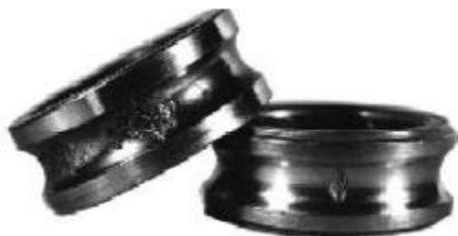
*Figure (I. 8) : Défaut sur la bague intérieure*
