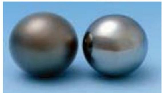
*Figure (I. 27) : Bille après passage de courant électrique*
