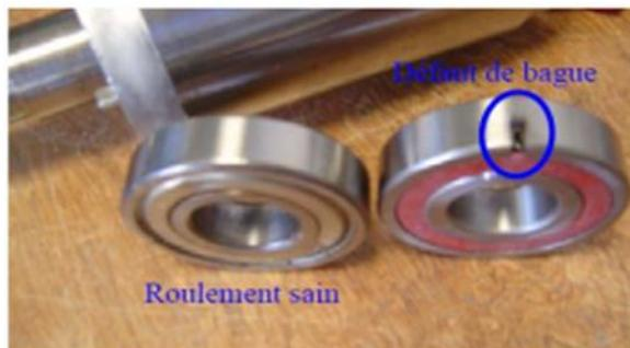
*Figure (I. 6) : Défaut sur la bague extérieure*
