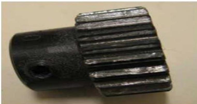
*Figure (I. 13) : L'usure d'engrenage*
