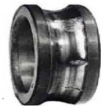
*Figure I. 26 : Écaillage d'une bague intérieure suite à un montage incorrect*
