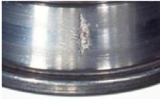
*Figure (I. 24) : Roulement abîmé*
