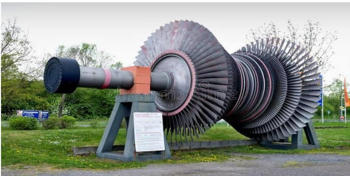
**Figure I.2 : Rotor d'une turbine à vapeur.**
