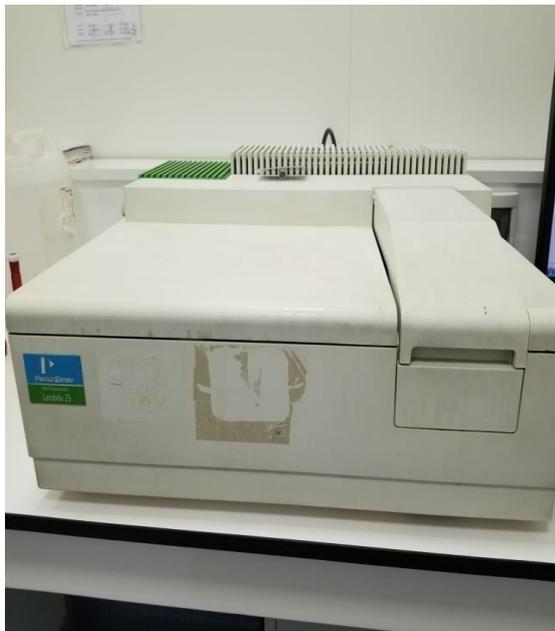
Figure 24 : UV Spectromètre.
