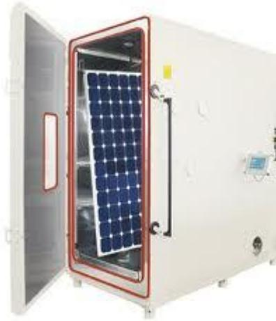
**Figure II-2.** Chambre climatique pour essai en chaleur humide.
