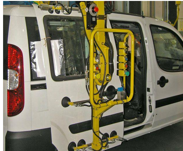
Figure I.24 : levage par ventouse [32]
