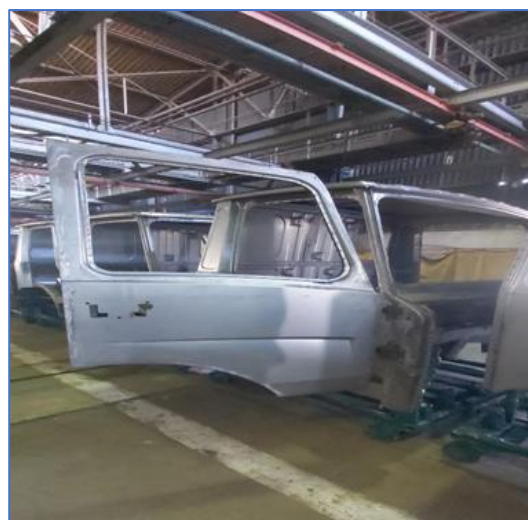
Figure II.2 : Position de la porte sur la cabine de camion k66
