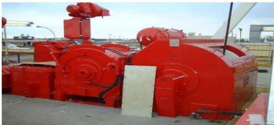
Fig. I. 6. Treuil de forage [3]
