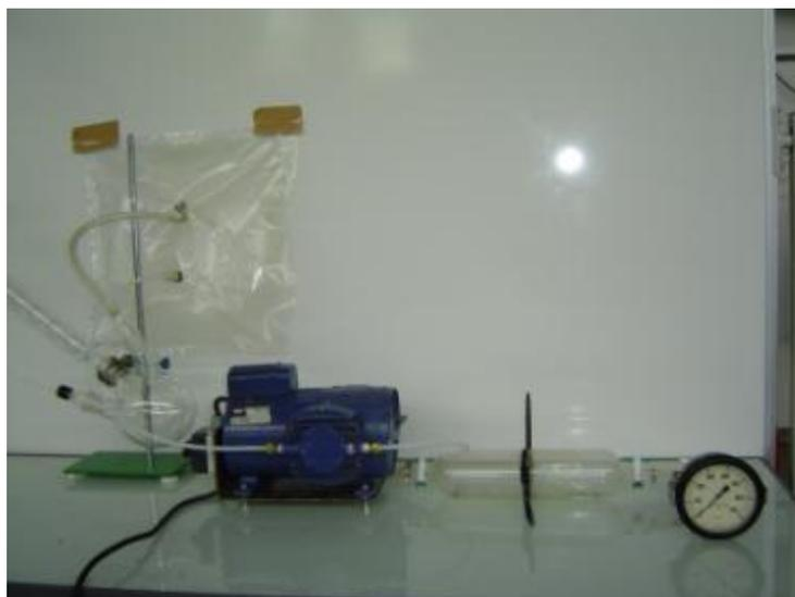
Figure 14 : Système d'échantillonnage des gaz permanent.
