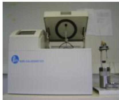
Figure 41 : Bombe calorimétrique
