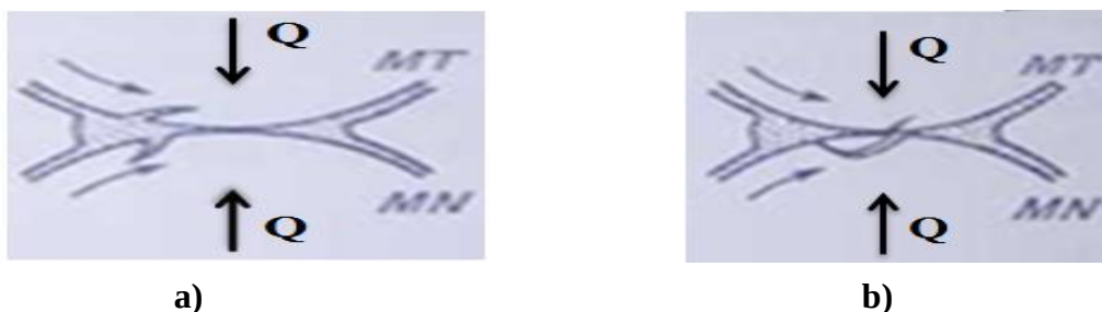
Fig.2.11 Schéma expliquant la fissuration des surfaces d'un contact hertzien mobile
