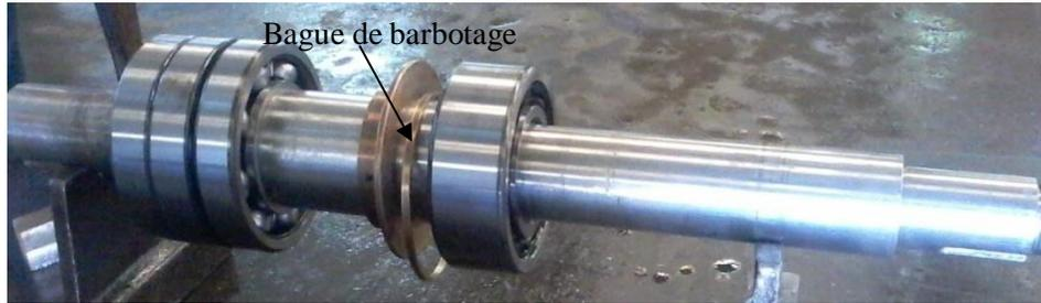
**Figure V.4 : Roulements et bague de graissages montés sur l'arbre.**
