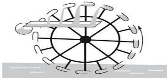
**Figure.II.1 : Illustration d'une roue à godets chinoise**
