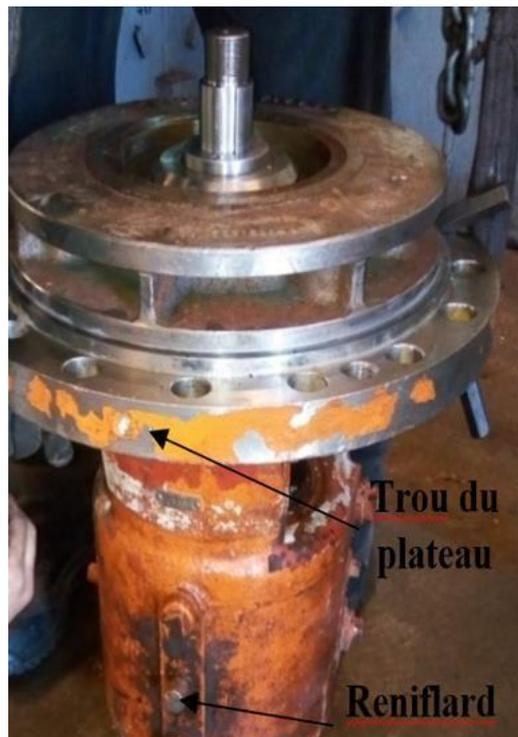
**Figure V.9 : Mise en place du plateau de garnitures.**
