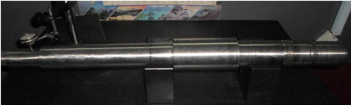
**Figure.V.2 : Vérification de la droiture d'arbre.**
