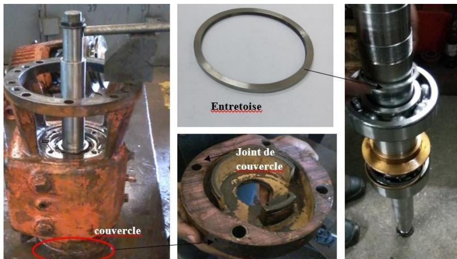
**Figure V.7 : Mesure du jeu axial.**
