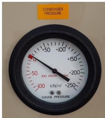
**Figure 3.10 :** Manomètre du condenseur.
