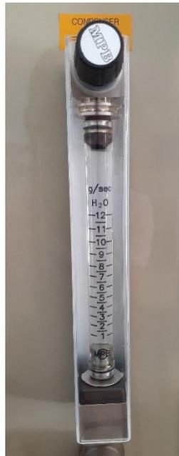
**Figure 3.11** : Débitmètre d'eau du condenseur.
