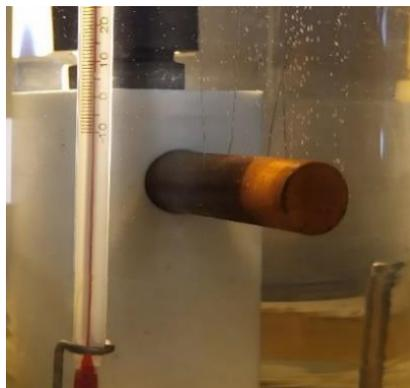
**Figure 3.5 :** L'élément chauffant de l'appareil.
