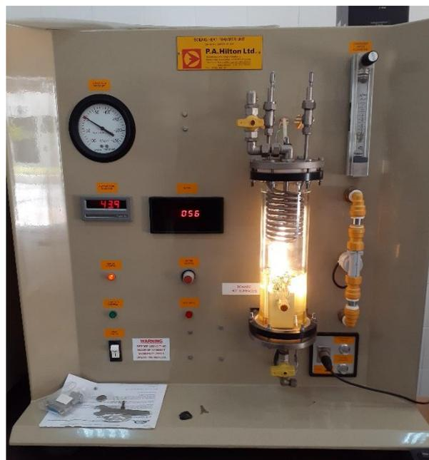
**Figure 3.1** : Photo prise de l'appareil de transfert de chaleur par ébullition H655.
