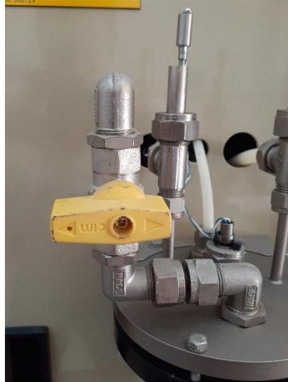
Figure 3.9 : La soupape de dégagement.
