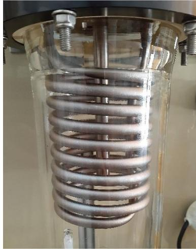
**Figure 3.6 :** La bobine du condenseur.
