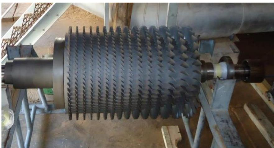
Figure I-2: compresseur axial
