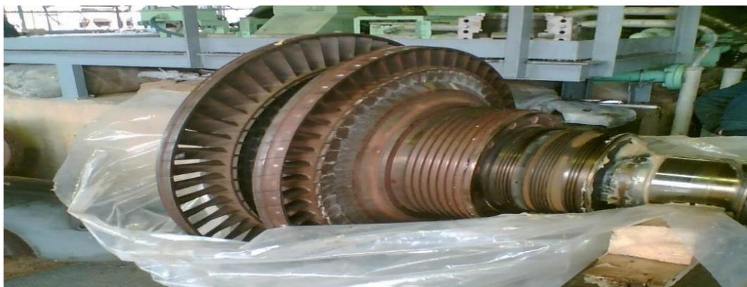
Figure : I.4 Roues de la turbine de charge.
