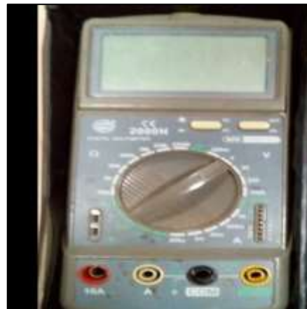
Figure III-9 : Voltmètre utilisé pour mesurer le potentiel de PC (Possède une impédance d'entrée élevée).
