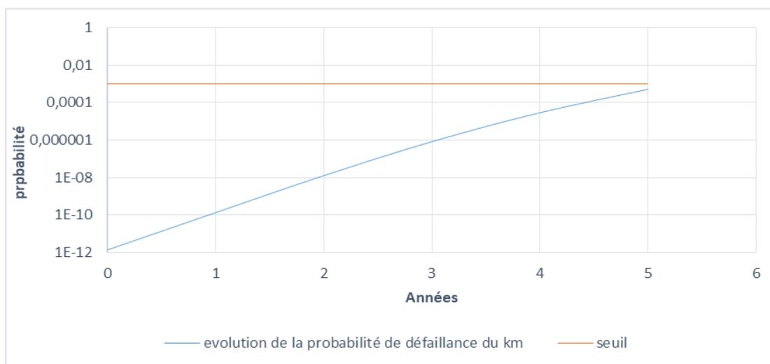
Figure V-20 Courbe d'évolution de la probabilité de défaillance du km 65 avant réparation par la norme DNV (RP-F101)
