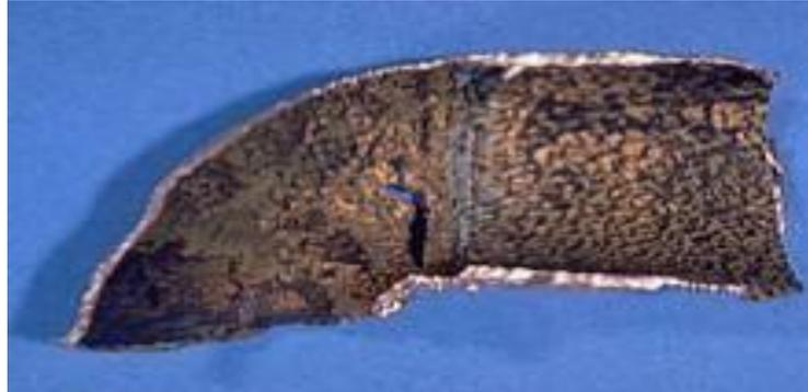
Figure II-2 Erosion d'une conduite
