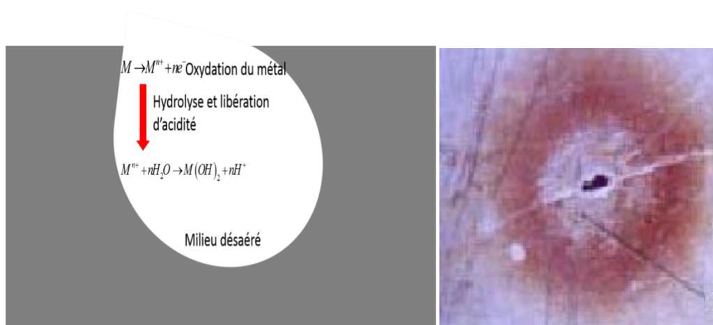
Figure II-8 Corrosion par piqûre
