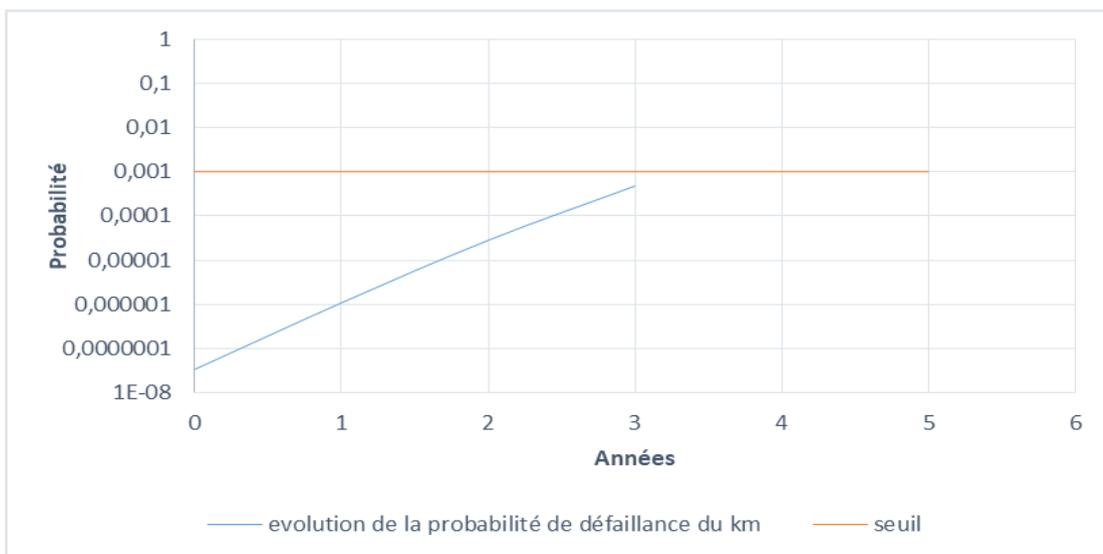
Figure V-23 Courbe d'évolution de la probabilité de défaillance du Km 65 après réparation par la norme Shell 92
