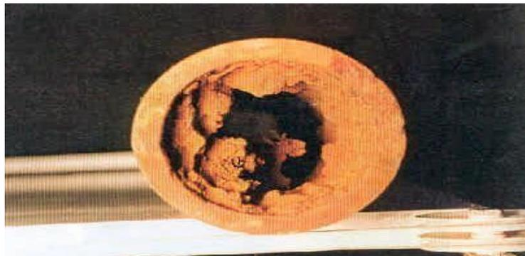
Figure II-3 Corrosion interne d'une conduite
