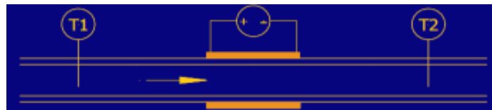
Figure II.17 : Principe du débitmètre thermique
