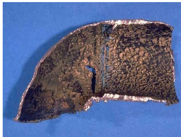
Figure II.8 : Corrosion avec frottement
