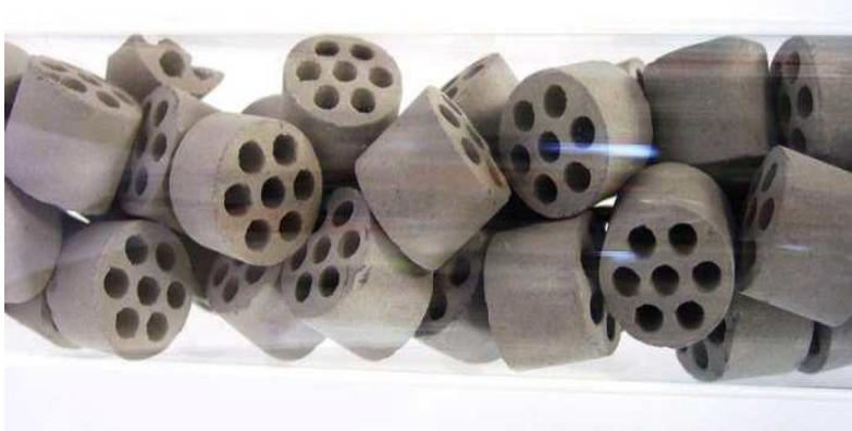
Figure III. 5 : Exemple de catalyseur de reformage (source Air Liquide).
