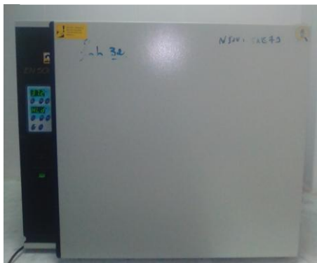
4-pour les milieux chapmane et HK et BCP et Manconky l'incubation dans l'étuve à 37°C pendant 24h.
