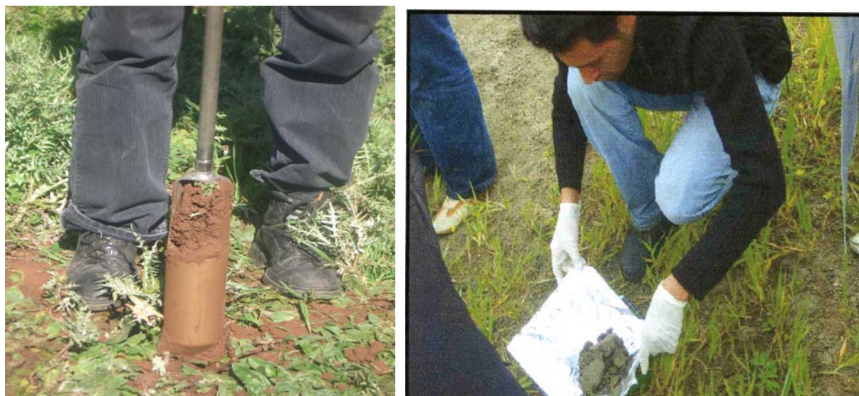
Figure 7 : Prélèvement et conditionnement des échantillons de sol
