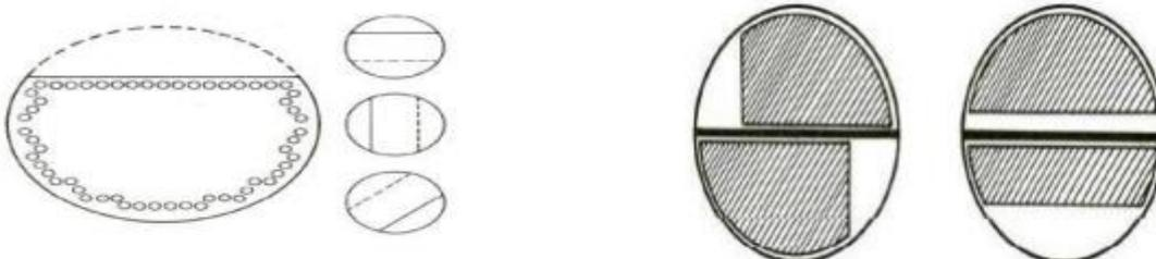
Figure III. 5: Chicanes transversales et longitudinales
