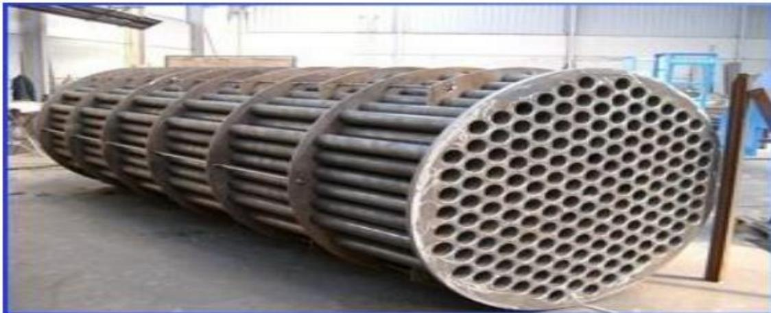
Figure III. 4: Faisceau tubulaire
