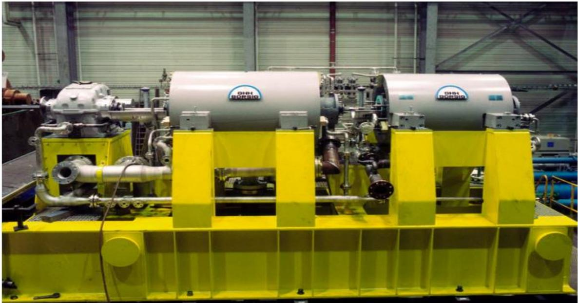
Figure V. 4: Compresseur centrifuge
