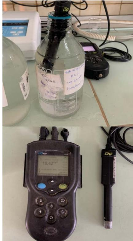
**Figure 31 :** Oxymètre Type HQ Modèle 40 D de marque «HACH»
