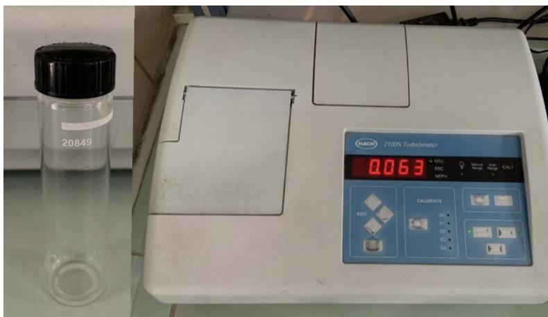
Figure 21 : Turbidimètre.
