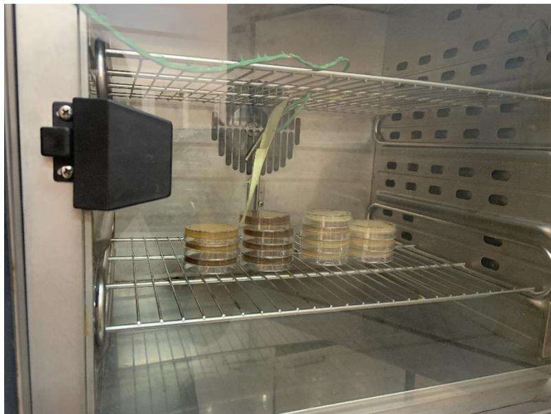
**Figure 40** : Incubation des milieux dans des boîtes de pétri avec le couvercle vers le bas.
