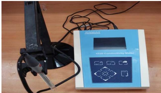
**Figure IV.2** : conductivimètre électrique
