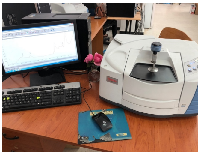
Figure III.1 : Photographie de l'appareil à spectroscopie infrarouge à transformée de Fourier [77].
