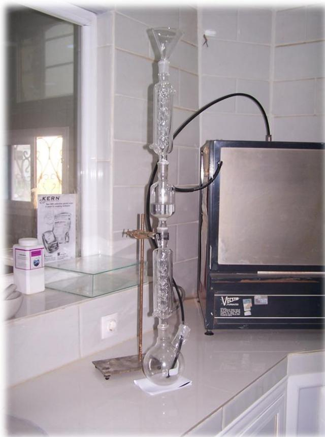
**Figure VI-3 :** Appareil simulant le procédé Solvay au laboratoire <sup>[48]</sup>.
