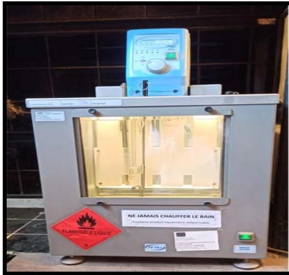
**Figure 12.** Appareil de mesure la viscosité (Viscosimètre).
