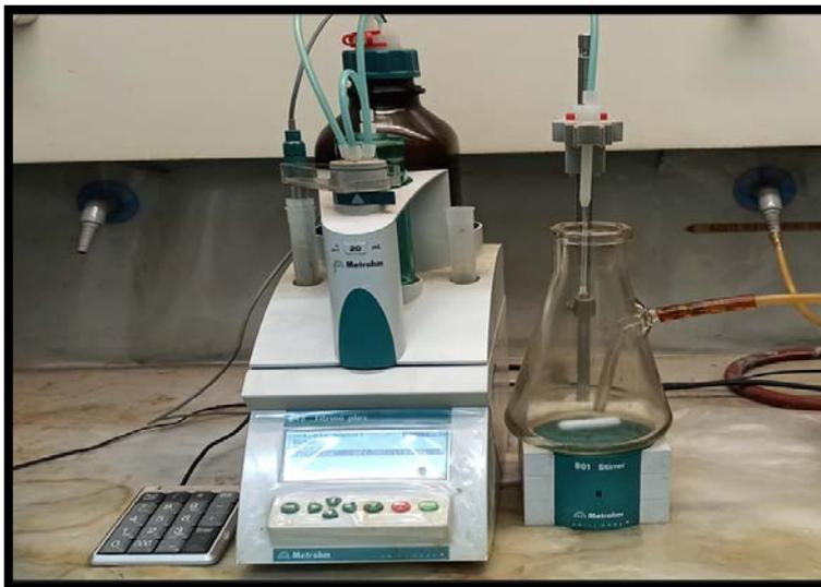
Figure 10. Appareil de mesure l'acidité.
