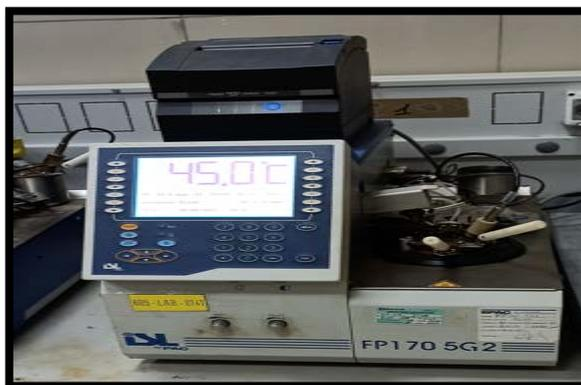
**Figure 13.** Appareil de mesure le point d'éclair (Abel).
