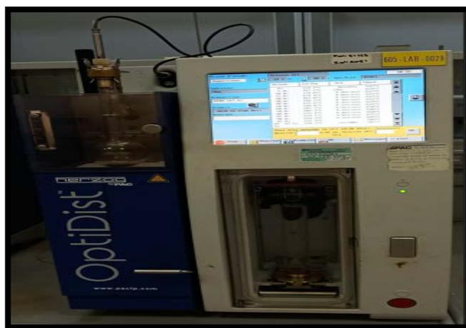
**Figure 11.** Appareil de mesure la distillation.
