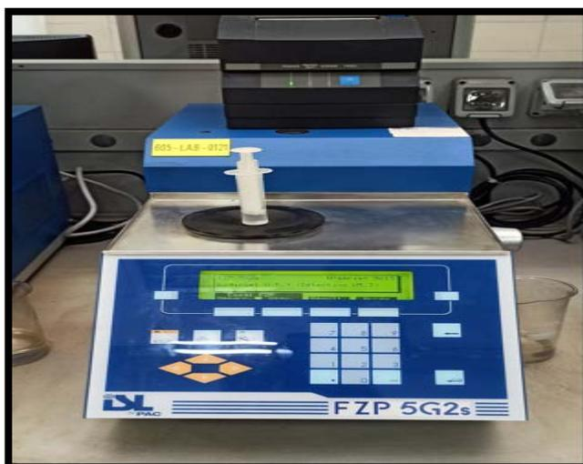
Figure 14. Appareil de mesure de point de congélation.
