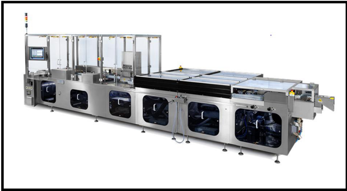
Figure II.3 : SARONG SAAS 15 machine automatique pour la production de suppositoires dans des cavités en aluminium thermo formable.
