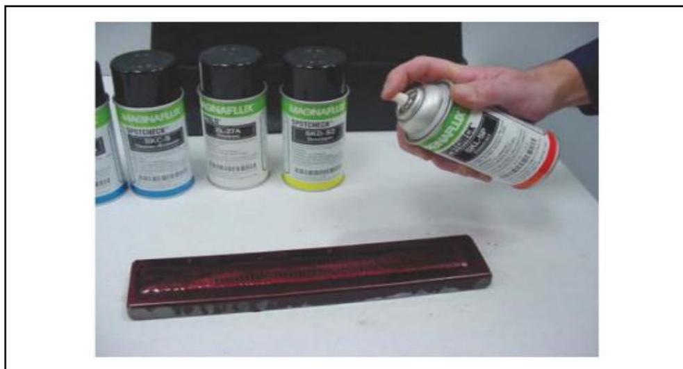
Figure I. 3: Inspection par le ressuage
