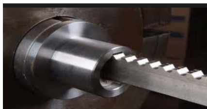
Fig. 36 Représentation du brochage intérieure
