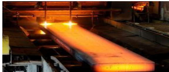
Fig. 49 Pièce d'acier en cours de laminage.
