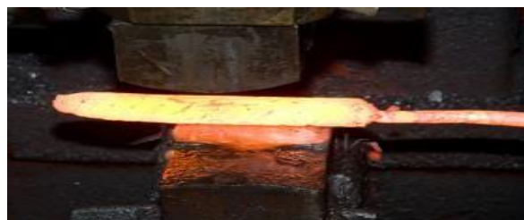
Fig. 47 Réalisation d'un brut en forge libre.
