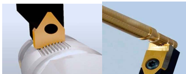
Fig. 38 Représentation du brochage extérieur.
