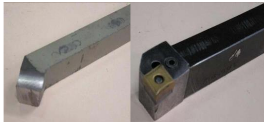
Fig. 14 Outils de coupe, (a) en acier rapide (ARS), (b) a plaquette en carbure métallique.
