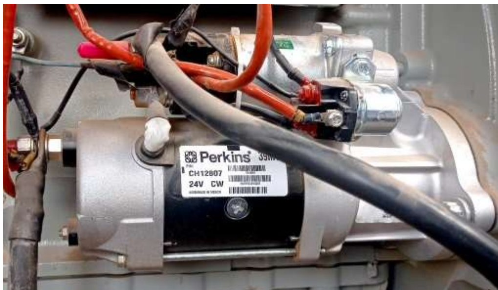
Figure 27 : démarreur de moteur
