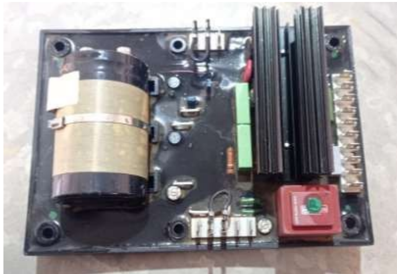
Figure III. 14: régulateur de tension
