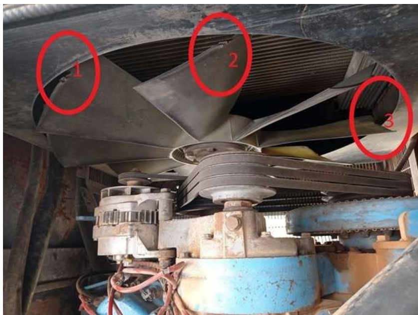
Figure 1. Défaits de contact de l'hélice du ventilateur.
