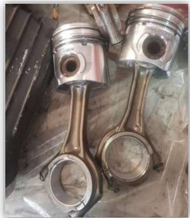
Figure 23: Les Pistons et les bielles
