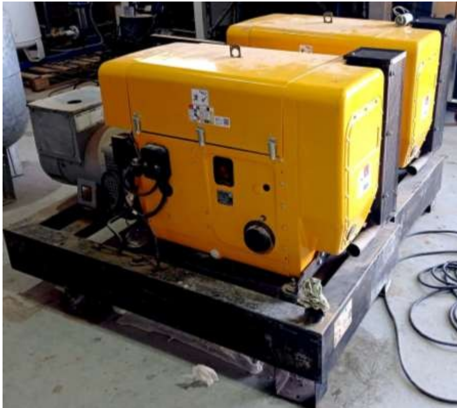
Figure III. 3: Groupe électrogène essence monté sur châssis 30KVA
