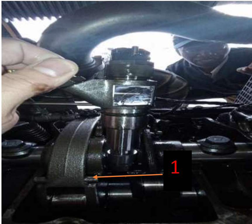
Figure4 : démontage des injecteur
