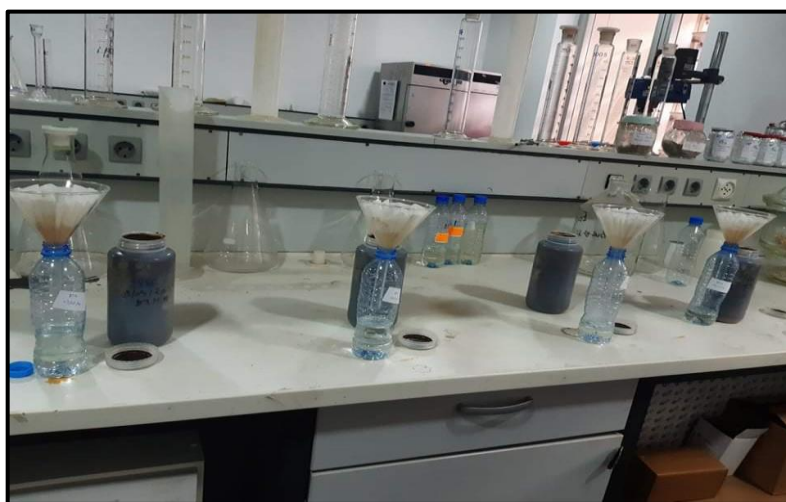
Figure 4 : Technique de préparation et de récupération du lixiviat.
