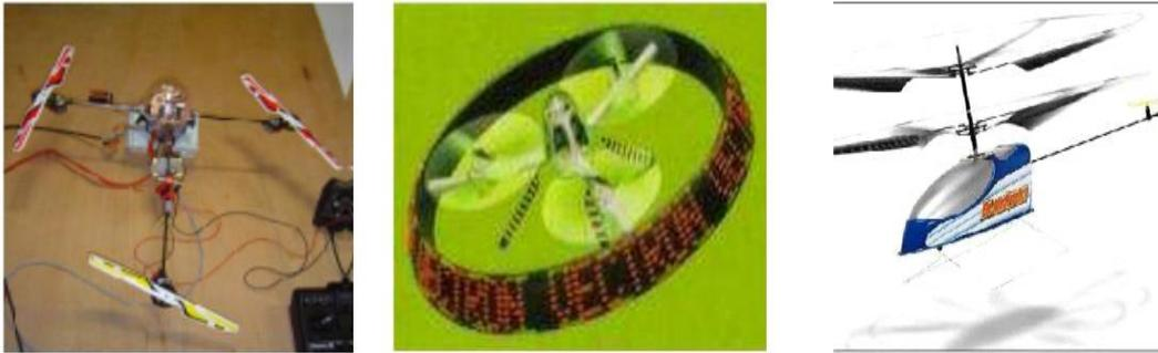
Figure 1.8: a-Trirotor b-Vectron c-Hélicoptère auto stable.
