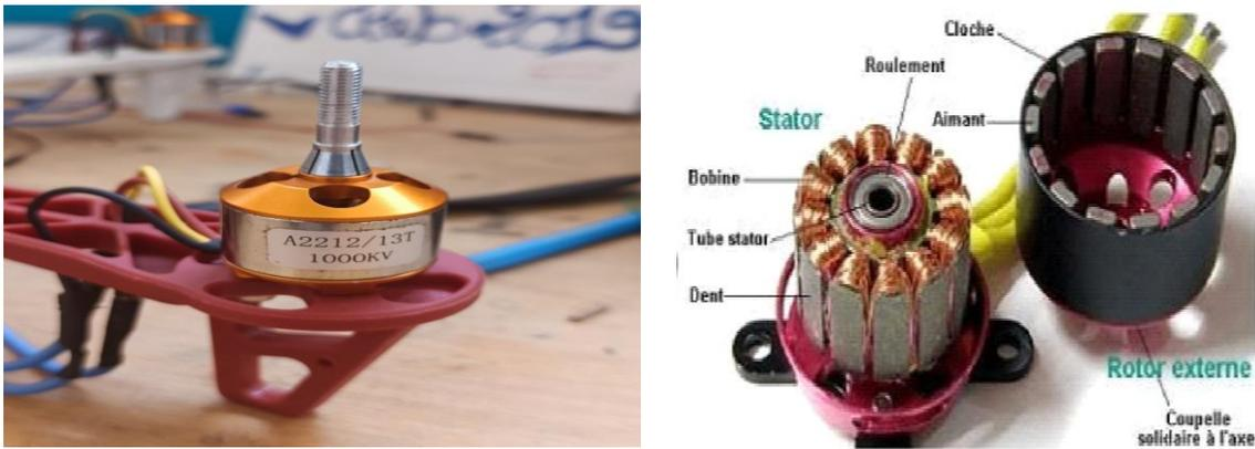
**Figure3. 3: Moteur brushless A2212/13T et Structure interne d'un BLDC**
