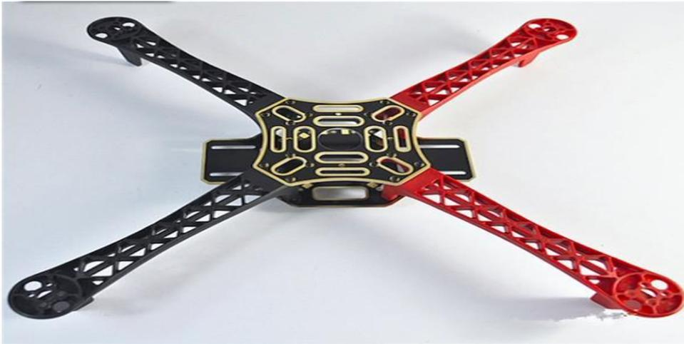
**Figure 3. 9: Châssis du drone**
