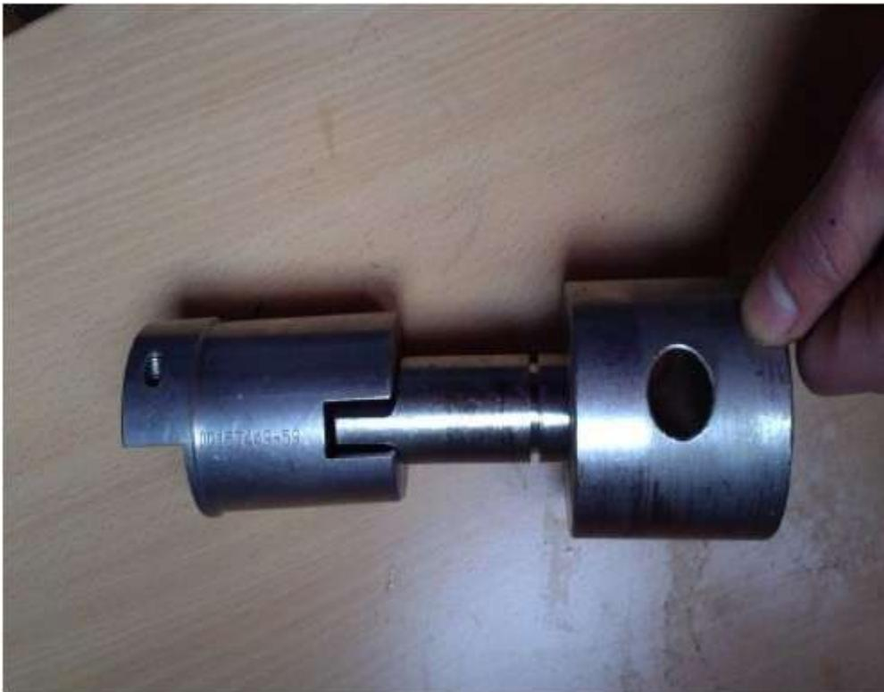
Figure III.23 : Assemblage Boisseau et Le Manchon.
