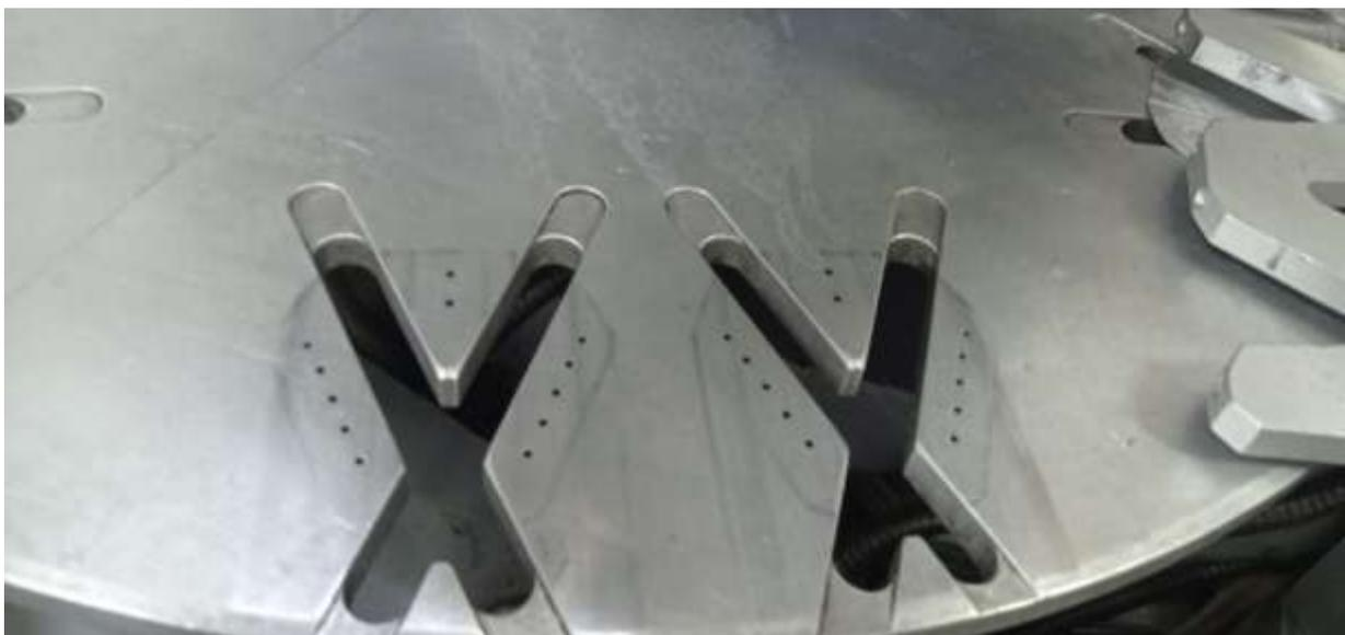
**Figure III.17 :** Les trous d'aspirateur de l'aire.
