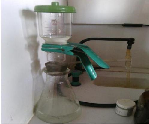
**Figure N°IV.4:**Filtration sous vide
