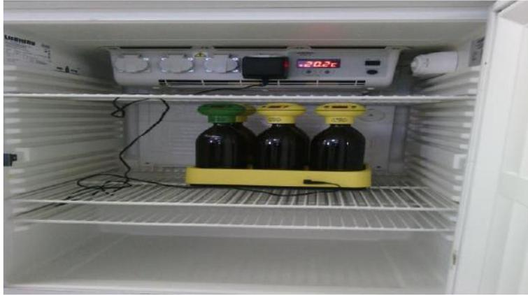
**Figure N°IV.8:** DBO mètre
