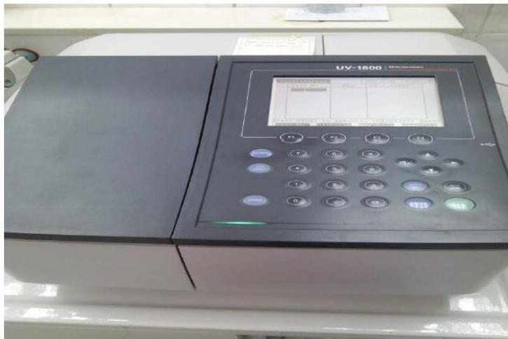
**Figure N°IV.12:**Spectrophotomètre (UV-VISIBLE)
