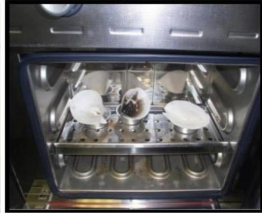
**Figure N°IV.5:**séchage à 105 °C
