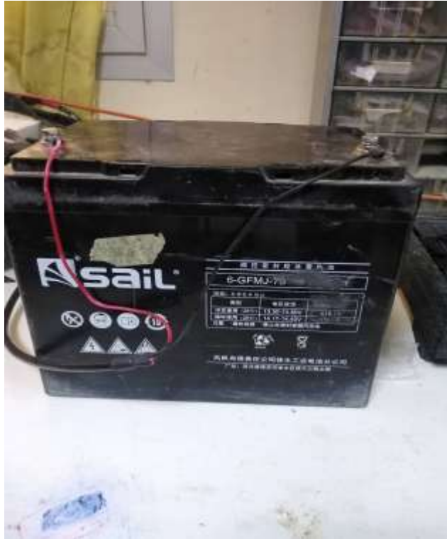
Figure III.6: une batterie a gel
