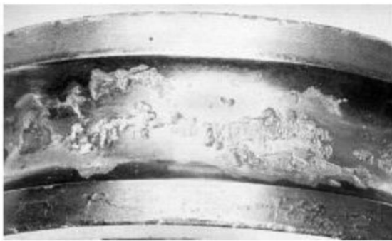
a. Dégradation d'un chemin de roulement
