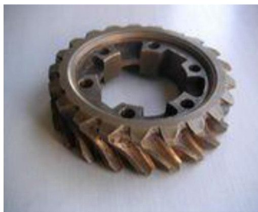
Figure I.5. Dégradation des dents d'une roue dentée [15].
