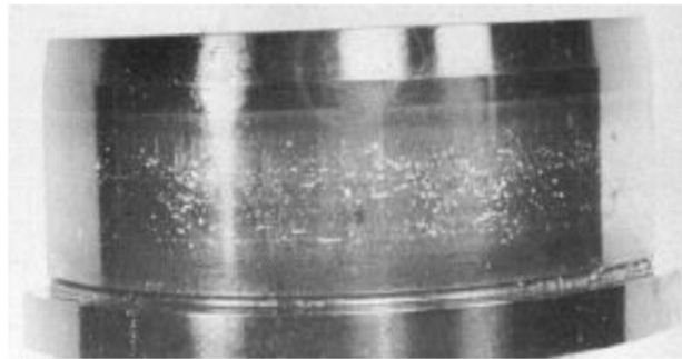
Figure I.20. Effet de la circulation du courant électrique sur le chemin de roulement[40]
