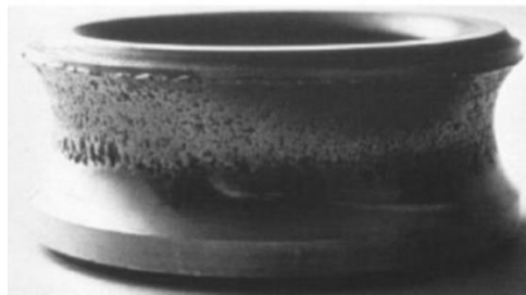
Figure I.14. Effet de la bague intérieure d'un roulement surchargé
