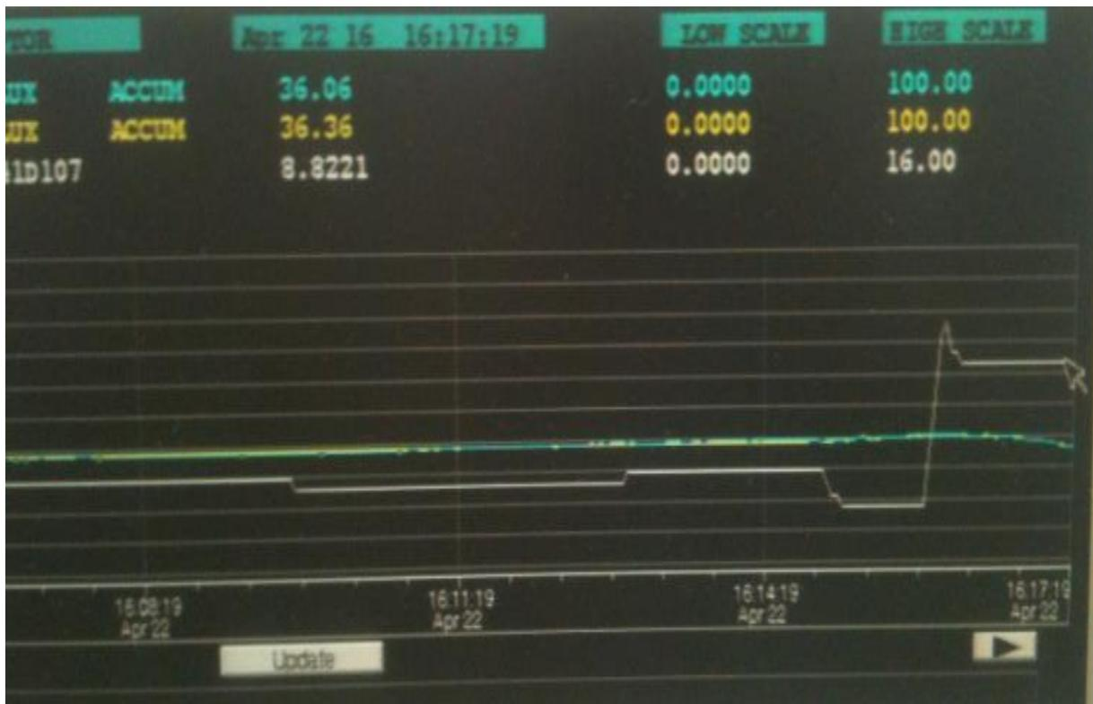
Fig. III.2 : Réponse indicielle expérimentale de la boucle interne réelle.
