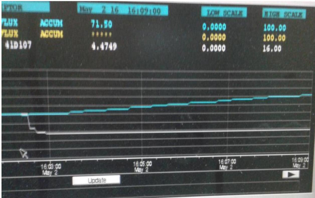
Fig. III.9 : Réponse indicielle expérimentale de l'objet principal en boucle ouverte.
